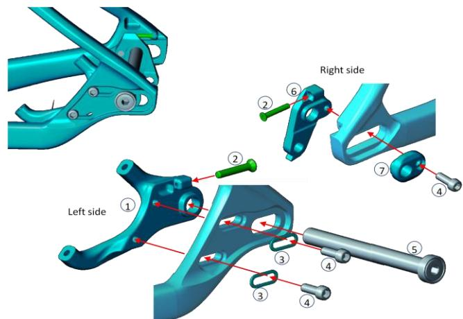
**5/135mm OLD replaceable Dropout / Derailleur Hanger kit:**
