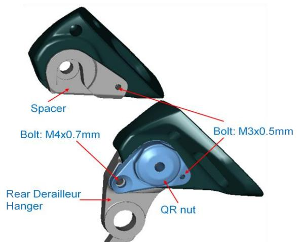
**12/142mm OLD replaceable Dropout / Derailleur Hanger kit:**
