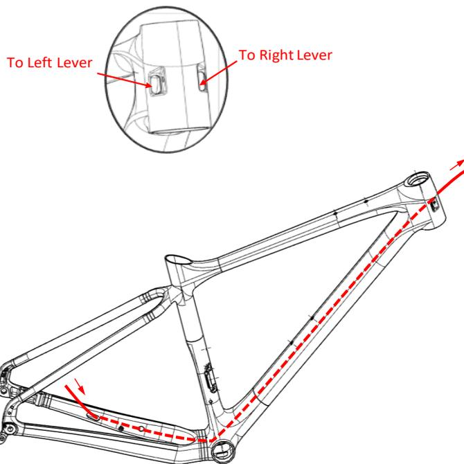
**Step 2: Installing the Derailleur Cable Guide**
