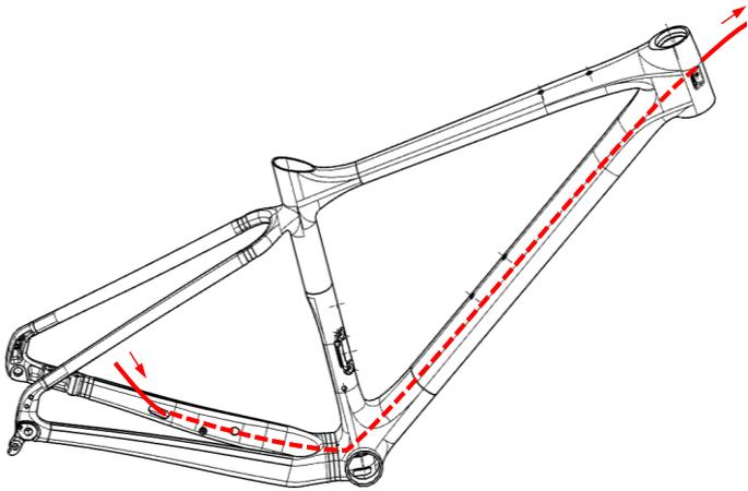
**Step 2: Installing the Derailleur Cable Guide**
