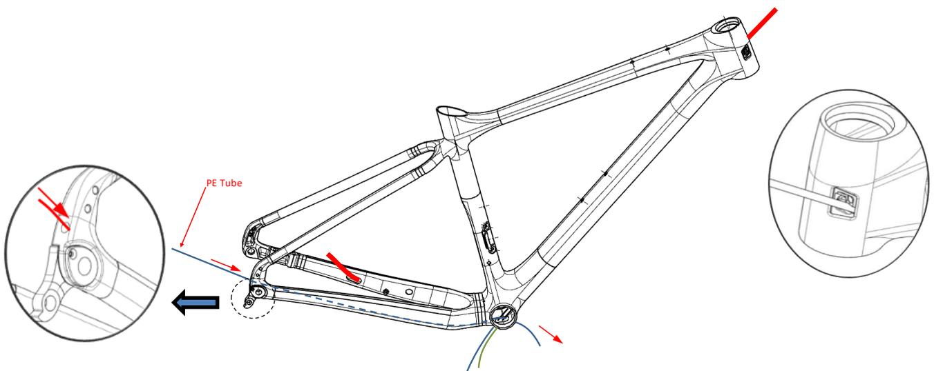
**Step 6 : Installing the Derailleur Wires**
