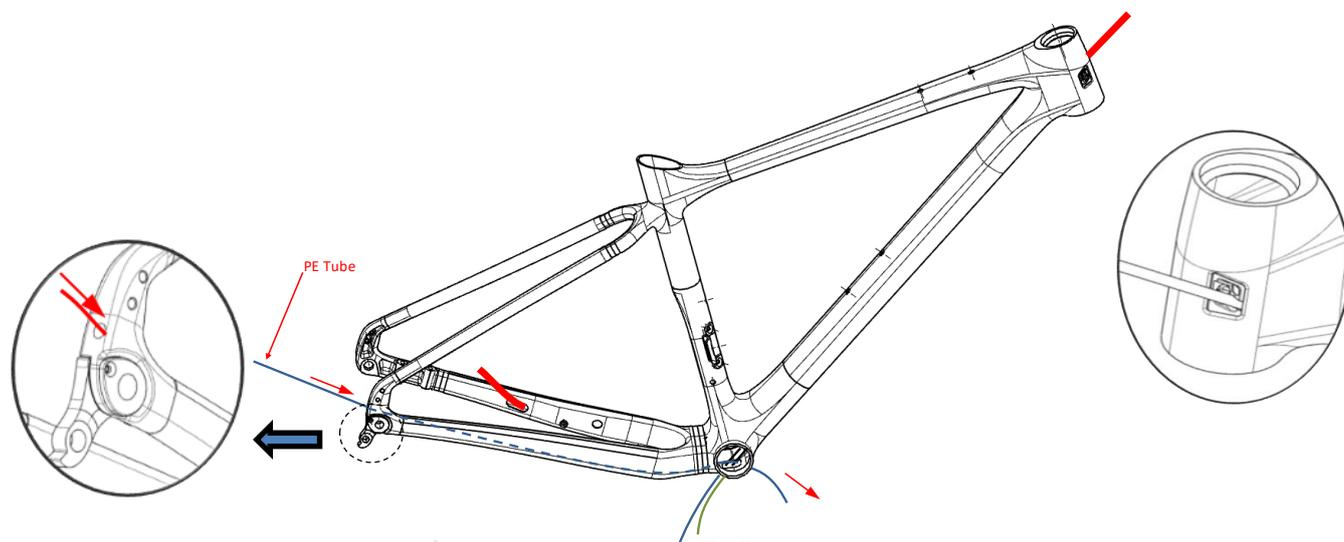
**Step 6 : Installing the Derailleur Wires**
